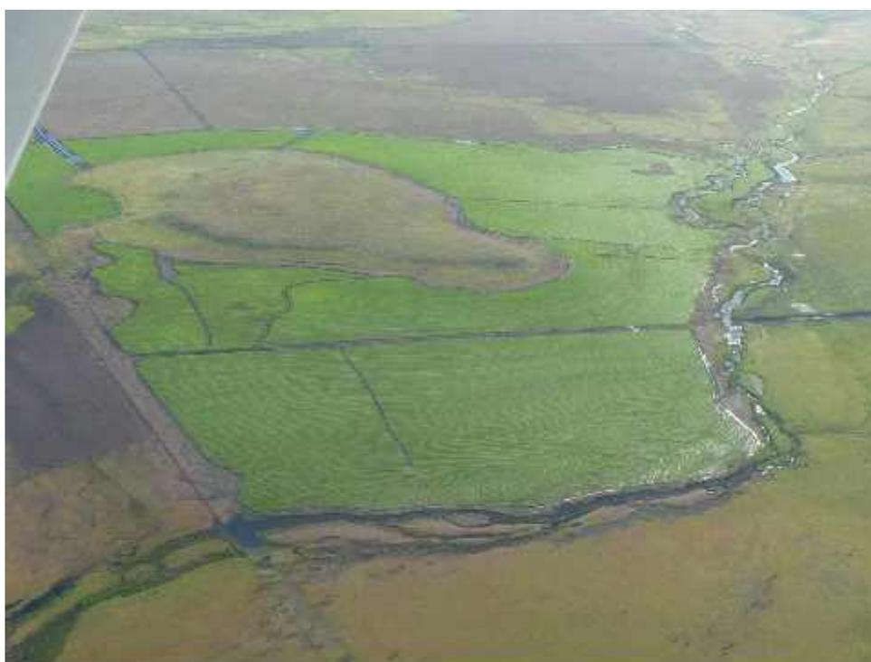
La sistematización de un suelo para cultivo de arroz consiste en diseñar un plan de manejo que permita regar y drenar el sitio seleccionado de forma eficiente, con el objetivo de obtener el mayor rendimiento posible, manteniendo la capacidad de producción de los recursos involucrados. Este plan involucra construcción de canales para riego y drenaje, caminos internos, nivelación de la superficie del suelo y construcción de taipas.
